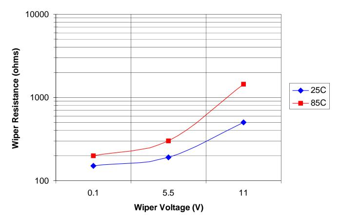
Figure 8. TYPICAL WIPER RESISTANCE VS WIPER VOLTAGE, CHARGE PUMP OFF
